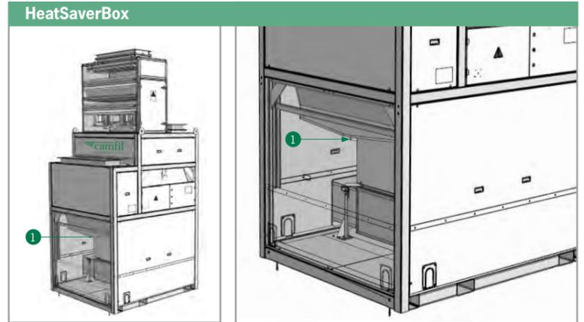
1 Kondensatanschluss Plattenwärmetauscher
