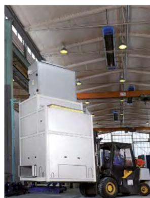
Einfacher Transport durch integrierte Gabelstaplerkufen und Kranösen
